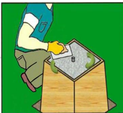
Figura 7. Acabado del concreto.
