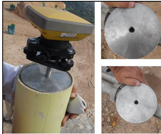
Ilustración 7. Plato de acero de 1" x 6" (rosca hembra en el centro de 5/8").
