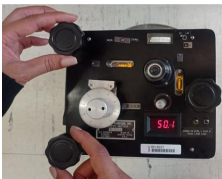
Imagen 9. Nivelación del gravímetro análogo.
