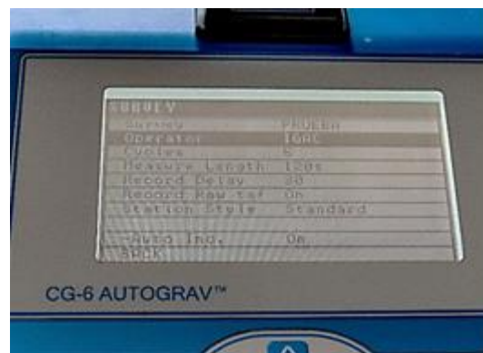
Imagen 7. Verificación del número de ciclos y la duración de lectura.
