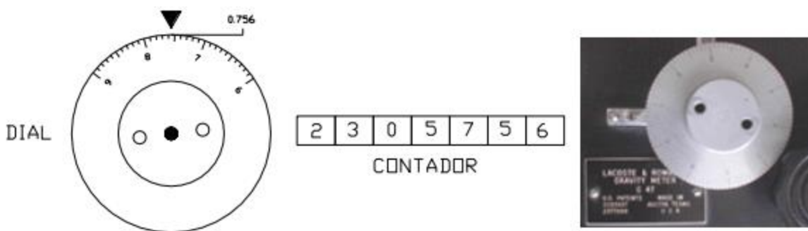
Imagen 13. Lectura instrumental de gravímetro análogo1.
