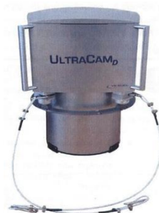
Figura 45. Empleo de las guayas de seguridad del SU
