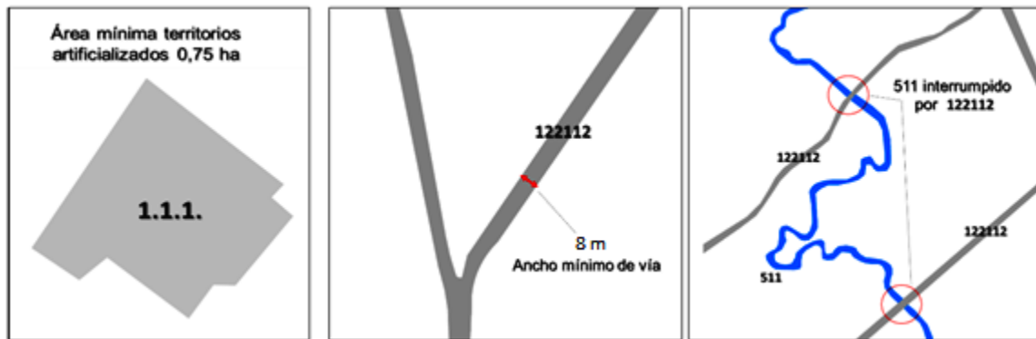
Figura 7. Representación de territorios artificializados, elementos lineales, y cruces de vías sobre ríos.
