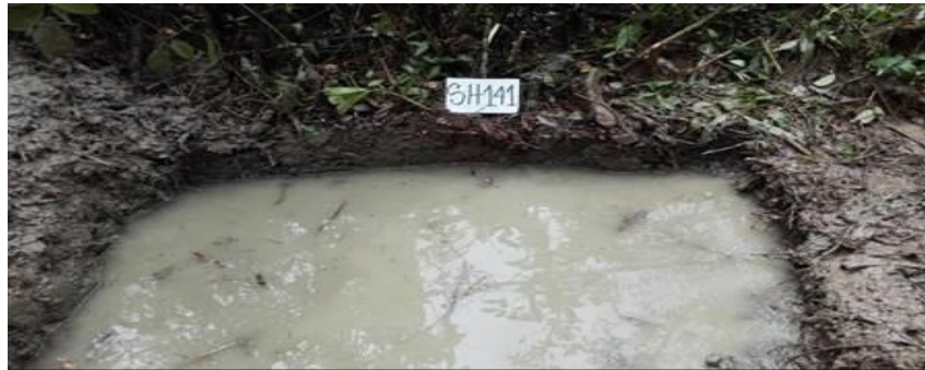
Figura 20. Nivel freático alto en suelos orgánicos (Fototeca IGAC, 2015)
