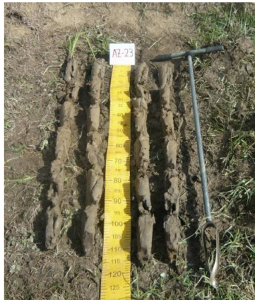
Figura 18. Muestras tomadas con barreno (Fototeca IGAC, 2015)
