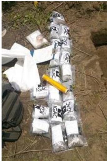
Figura 17. Toma de muestras para análisis de laboratorio (Fototeca IGAC, 2016)
