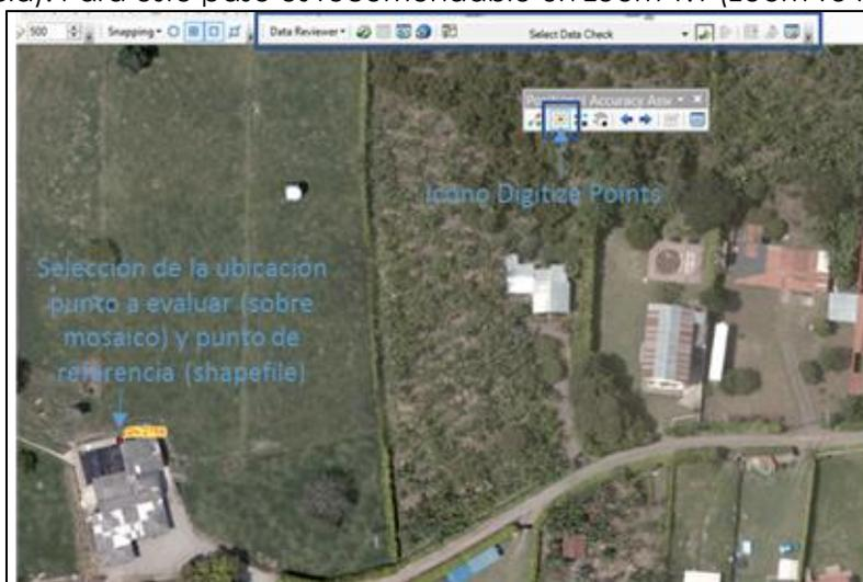
Ilustración 11 Selección de los puntos a evaluar vs los de referencia en Data Reviewer
