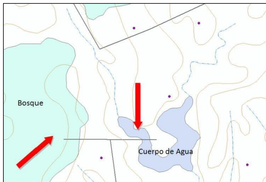
Figura 40. Ejemplo - Error de consistencia lógica: Cerca sobre cuerpo de agua.
