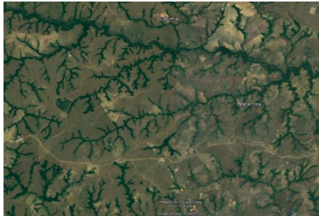
Imagen 4. Patrón de drenaje subdendrítico. Imagen tomada de Google Earth, 2017.
