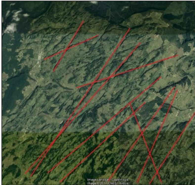
Imagen 24. Fracturamiento de rocas municipio de Sucre, Santander. Como se observa en la imagen, las rocas presentan diaclasamiento sin una dirección definida, contrario al fallamiento. Las fracturas más representativas se resaltan en color rojo. Imagen de Google Earth, 2017.
