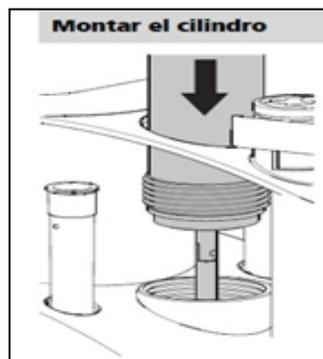
Imagen 8. Montaje del cilindro.
