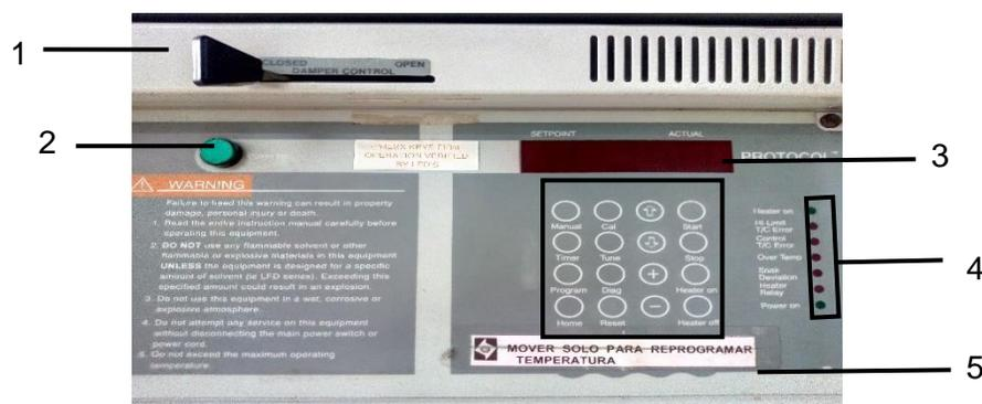
Imagen 1. Constituyentes principales del horno termostático
