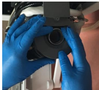
Imagen 8. Retiro soportes del lente
