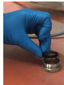
Imagen 8. Retiro soportes del lente
