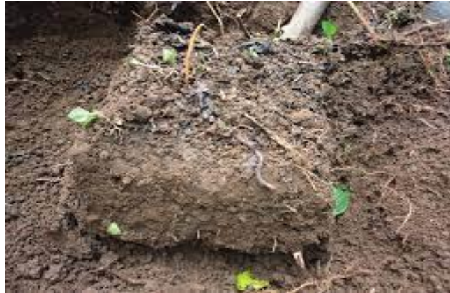
Figura 4. Muestra de suelo para análisis de estabilidad estructural.
