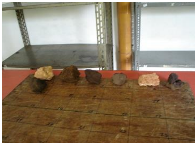
Figura 2. Muestras de suelo para densidad aparente por método del terrón parafinado.
