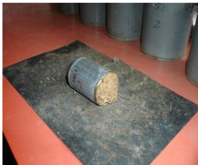
Figura 3. Muestra de suelo para densidad aparente por método del cilindro.
