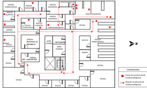
Ilustración 7. Plano Laboratorio Nacional de Suelos, tercer piso.
