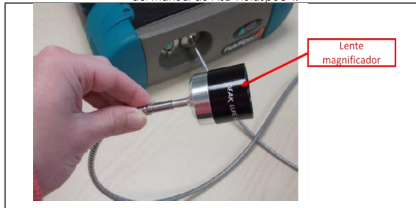
Ilustración 4: Inserción de la fibra óptica en el lente magnificador. Imagen del manual de ASD FieldSpec 4.
