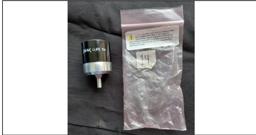
Ilustración 3: Lente magnificador para verificación de fibra óptica.
