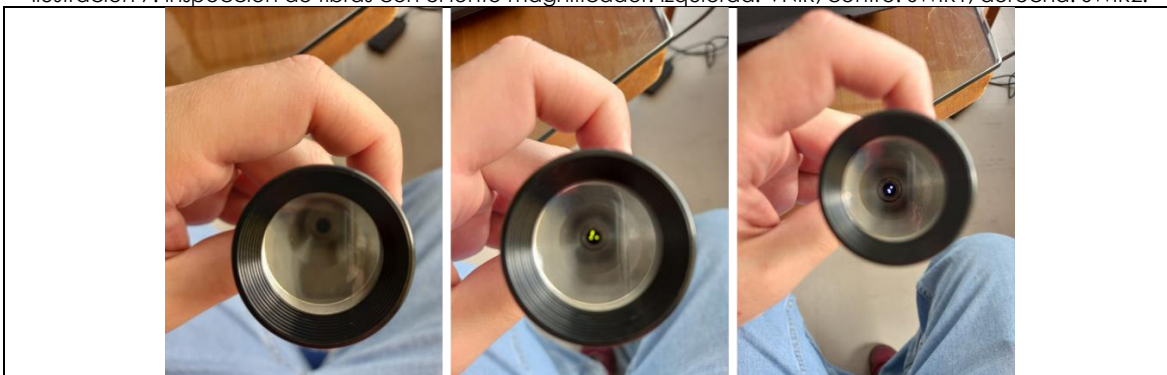
Ilustración 7: Inspección de fibras con el lente magnificador. Izquierda: VNIR, centro: SWIR1, derecha: SWIR2.
