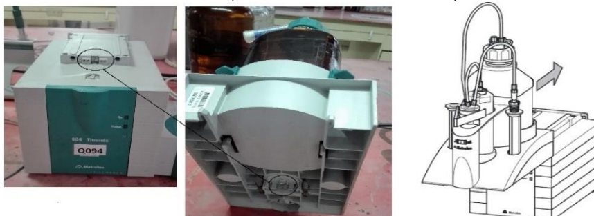
Ilustración 15. Empalme unidad de dosificación y titulador
